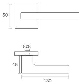
**Nota:** Inclui entrada de chave quadrada com base metálica 9 mm de espessura
