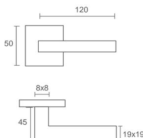
**Nota:** Inclui entrada de chave quadrada com base metálica 9 mm de espessura
